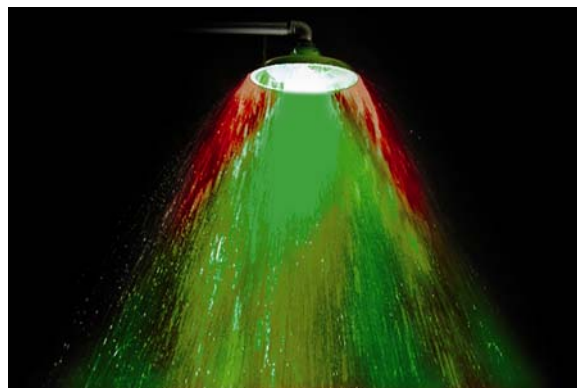
Fot. 8. Różnica pomiędzy klasycznym kształtem strumienia (kolor czerwony) a kształtem strumienia z nadanym ruchem wirowym (kolor zielony)
